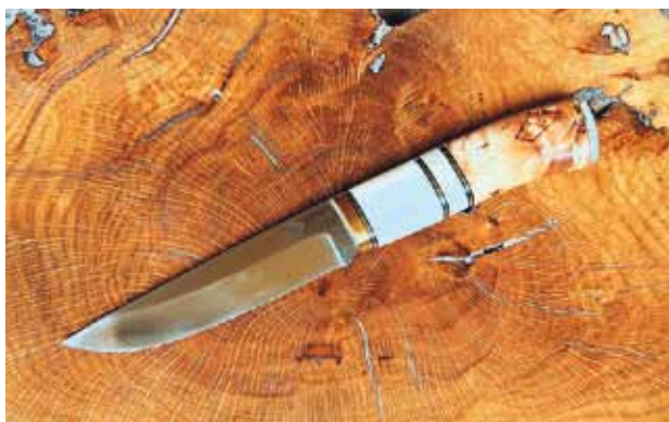
Nóż z niskim szlifem płaskim. Taki nóż nadaje się do strugania drewna, ale do cięcia mięsa już nie bardzo
